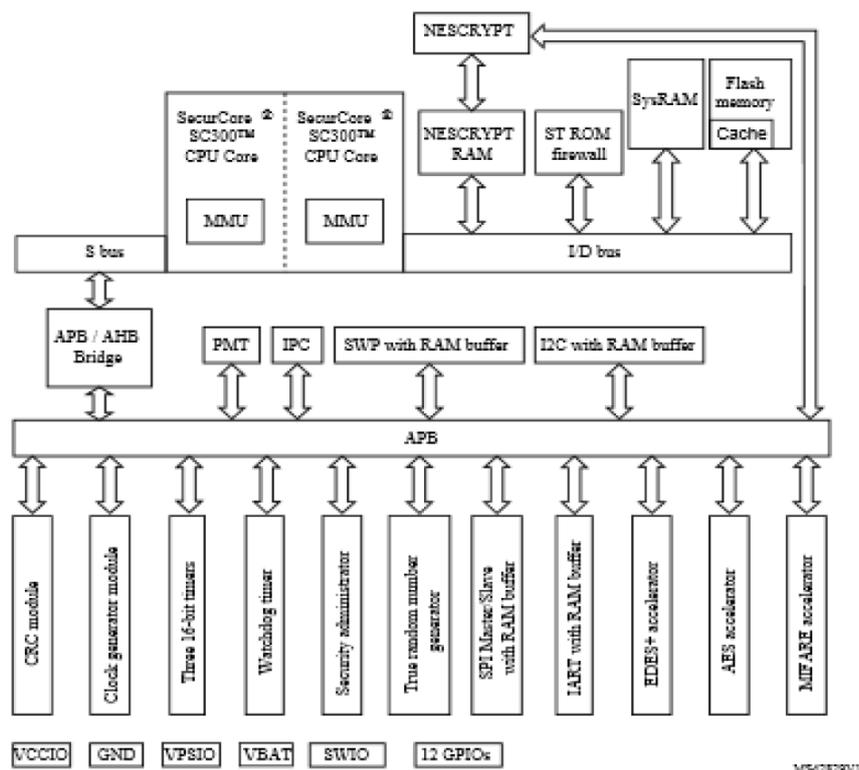
Figure 2 : Architecture du microcontrôleur ST54J A01
