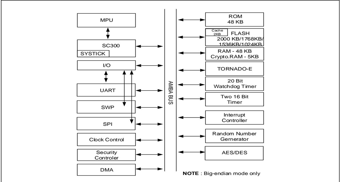
**Figure 1 S3FV9RR/S3FV9RQ/S3FV9RP/S3FV9RK Block Diagram**
